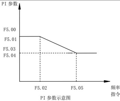
变频器运行在不同频率下，可以选择不同的速度环 PI 参数。运行频率小于切换频率 1 (F5.02) 时，速度环 PI 调节参数为 F5.00 和 F5.01。运行频率大于切换频率 2 (F5.05) 时，速度环 PI 调节参数为 F5.03 和 F5.04。切换频率 1 和切换频率 2 之间的速度环 PI 参数，为两组 PI 参数线性切换，如图所示：
