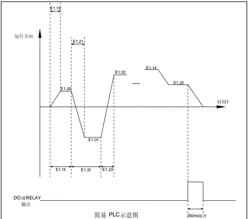
变频器完成一个循环后，自动开始进行下一个循环，直到有停机命令时停止。
