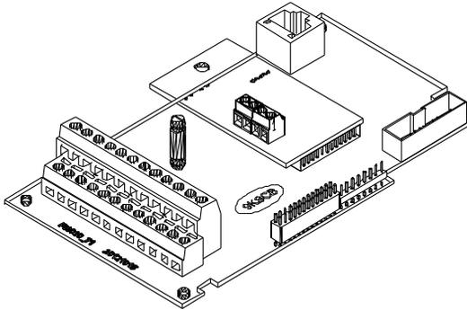
图 2.1 CAN 总线通信卡在 SCB 上的安装
