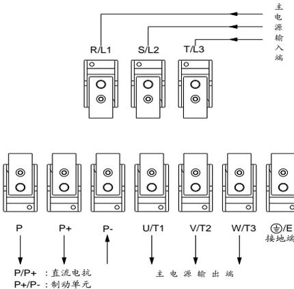
注: P/P+标准配置为短接状态; 若外接直流电抗, 则断开后再接。
