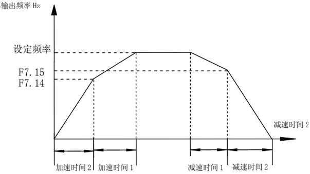
加减速时间切换示意图
