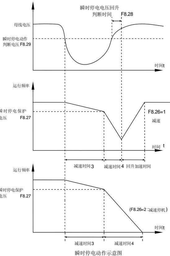
此功能是指，在瞬间停电或电压突然降低时，变频器通过降低输出转速，将负载回馈能量补偿变频器直流母线电压的降低，以维持变频器继续运行。
