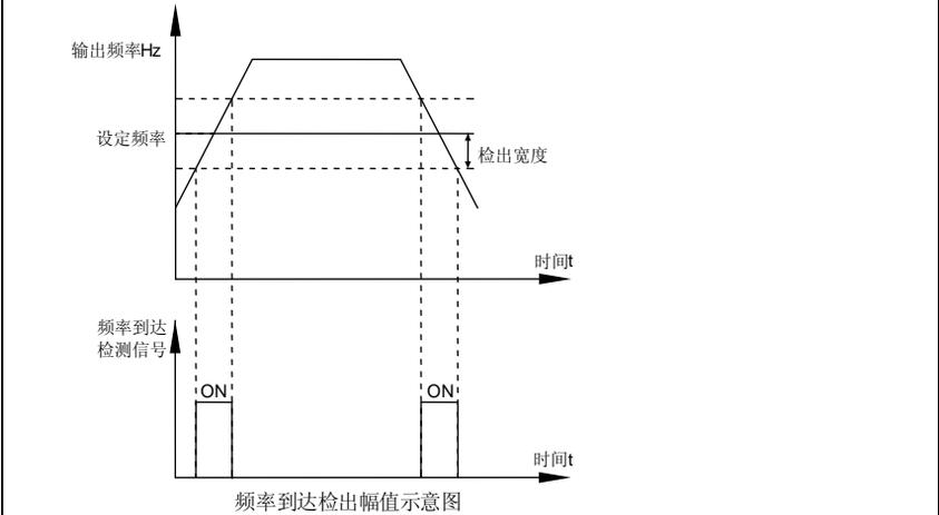
变频器的运行频率，处于目标频率一定范围时，变频器多功能 DO 输出 ON 信号。
