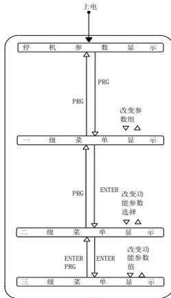
图3-2 显示状态及操作流程
