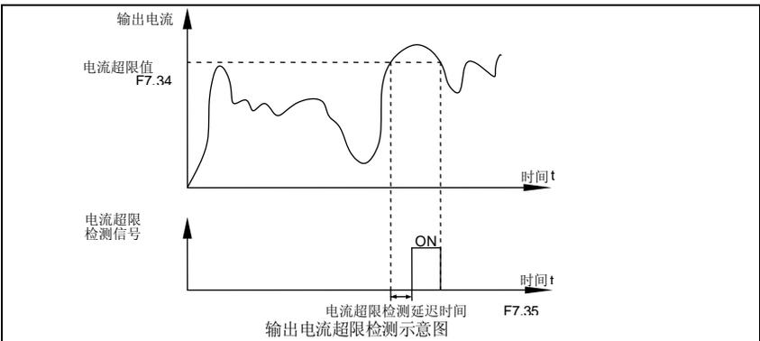
当变频器的输出电流大于或超限检测点，且持续时间超过软件过流点检测延迟时间，变频器多功能 DO 输出 ON 信号，图为输出电流超限功能示意图。
