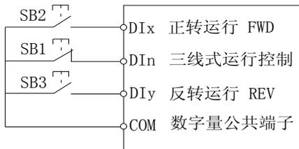
图 5-5: 端子命令方式: 三线制控制模式 1
