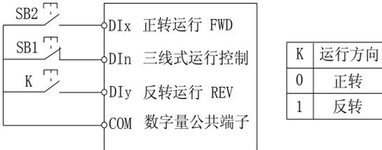
图 5-6：端子命令方式：三线制控制模式 2
